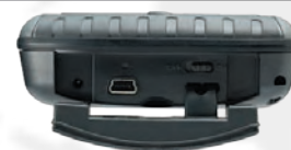
Switch Power On/Off Mini USB x 1
