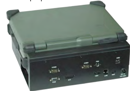
Station d'accueil avec slot PCI, interface video VGA/DVI et Adaptateur véhicule intégré (DC 12V-32V)
